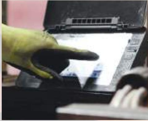
Carcasa resistente, con amortiguación de choques y a prueba de polvo y agua (IP 54)
