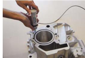
1. **Posicionar** la sonda en la muestra a ensayar. La sonda se deberá encontrar perpendicular a la superficie ( $\pm 5^\circ$ ). La base especial se puede usar para aumentar la repetibilidad y evitar la distorsión de los resultados, véase el capítulo “14. Información de pedido”.
