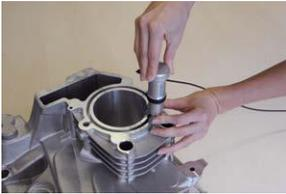
1. **Posicionar** la sonda en la muestra a ensayar. Para superficies planas, la base estándar es la más apropiada. Para objetos cilíndricos se recomienda usar una de las bases especiales. Para lugares de difícil acceso, se podrá usar un trípode. Véase el capítulo “14. Información de pedido”.
