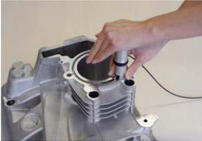
2. **Presionar** la sonda de modo lento pero firme contra la superficie para ejecutar la medición. Suprimir vibraciones en la mayor medida posible y observar las instrucciones en la pantalla.
