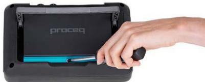
Figura 1: Insertar la batería
