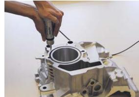
2. **Presionar** la sonda de modo lento pero firme contra la superficie hasta que se haya alcanzado la fuerza de medición seleccionada. El instrumento indicará el momento de separar la sonda a través de un aviso en la pantalla y un sonido audible.
