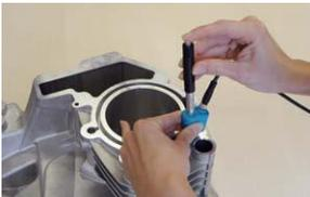
1. **Cargar** el dispositivo de impacto mientras que no esté en contacto con la pieza de ensayo sosteniéndolo firmemente con una mano y hundiendo el tubo de carga con la otra mano hasta que sea agarrado por el embrague.
