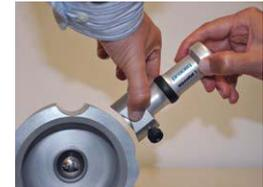
Figura 18: Bases especiales Portable Rockwell
