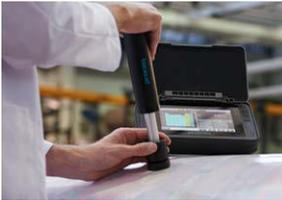
1. **Posicionar** la sonda en la bobina a ensayar. Asegurarse de que el anillo de soporte esté completamente posicionado en la bobina para garantizar un impacto perpendicular a la superficie de ensayo.
