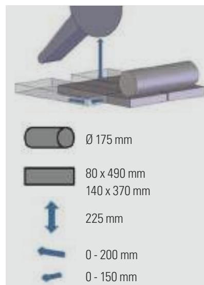
\* Les schémas de coupe ont été conçus à titre informatif. Ils représentent l'espace de coupe maximal théorique pour chacune de nos tronçonneuses. Les capacités de coupe décrites sont à moduler en fonction des matériaux et des cadencements. Les courses varient en fonction de la taille des tables.
