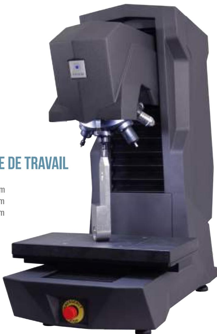
Entièrement automatique et très silencieux, le Duromètre PRESI est équipé de deux cellules de force, qui lui permettent d'appliquer des charges de 10g à 50 kg.
