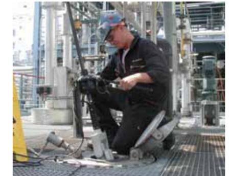
Inspección de depósito de planta química con sistema de inspección Ca-Zoom® PTZ
