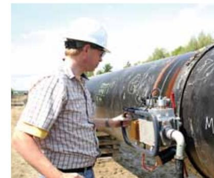
Sistema móvil de inspección ultrasónica Weldstar
