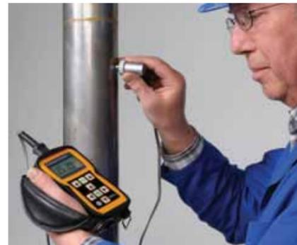
Medición ultrasónica del espesor de ductos DM5E
