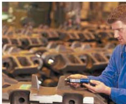
Medidor de dureza DynaPocket
