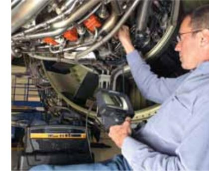
Inspección de motor de aeronave usando VideoProbe XLG3™
