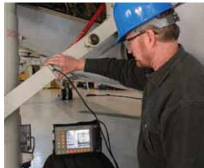
Inspección con el detector de fallas ultrasónico «phased-array» Phasor XS™ de la estructura de una aeronave
