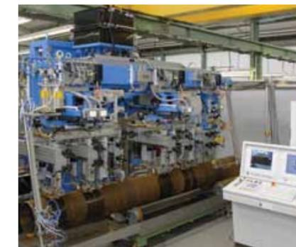
Sistema de ultrasonido de pruebas de ductos SNUP
