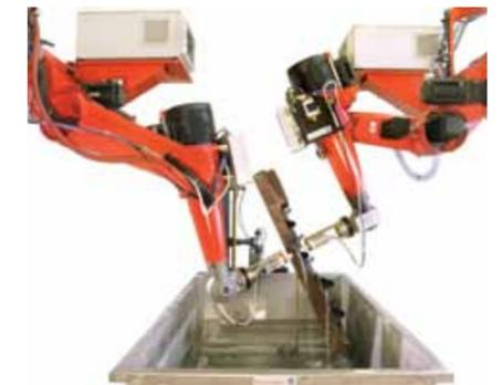
Pistola de agua en «phased-array» con robots
