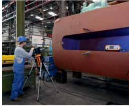
Inspección de componentes de aeronave utilizando rayo X industrial
