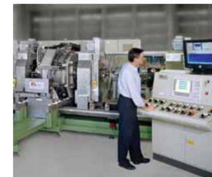
Sistema de ultrasonido de pruebas de barras, tuberías y ductos ROTA
