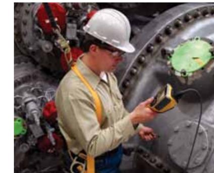
Inspección de turbina a gas con VideoProbe® XL Go™
