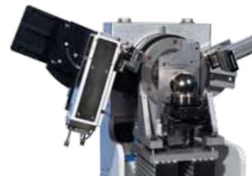
Analizador de esfuerzo DRX con detector Meteor1D
