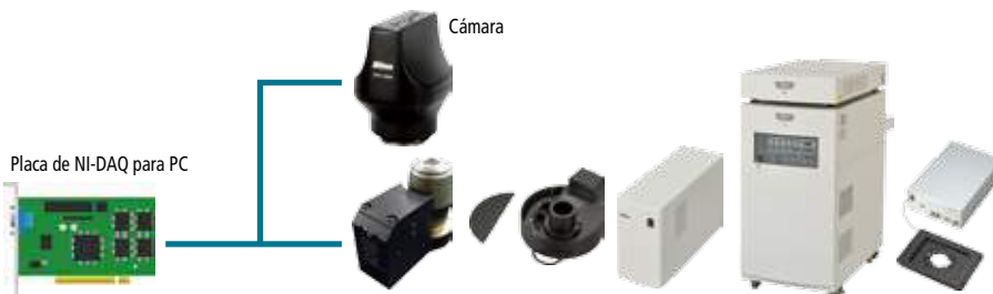
Dispositivos que admiten control TTL/analógico: Obturador, accionamiento piezoeléctrico, fuente de luz, rueda de filtro, etc.
