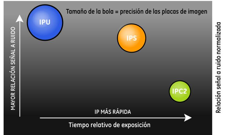
Este gráfico muestra las diferencias relativas en la velocidad, la relación señal a ruido normalizada y la precisión de las placas de imagen de GE que utilizan rayos X.
