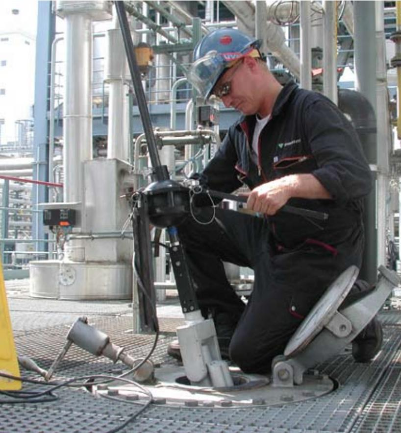
Inspección de una vasija de una planta de productos químicos con el sistema PTZ140, polo de extensión y trípode de bola de giro.
