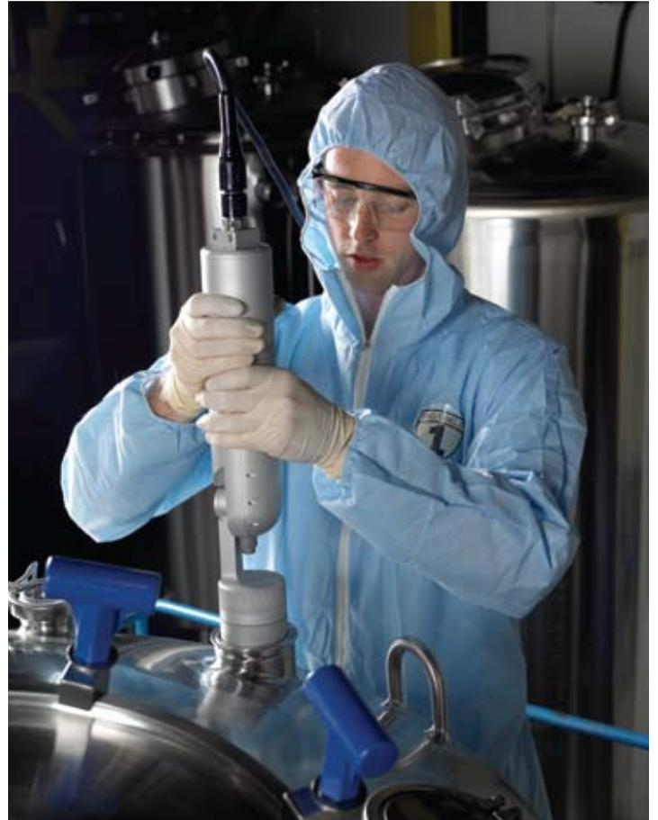
Inspección del tanque farmacéutico mediante una boca de 76 mm (3,0 pulg.)
