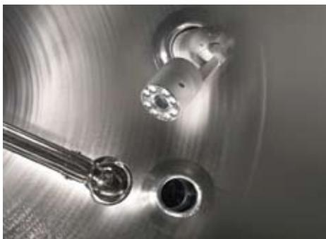
Inspección de la cabeza con forma de bola del rociador para la validación de limpieza
