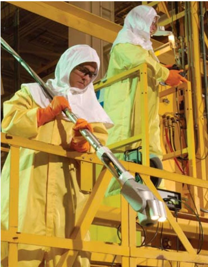
Los operadores realizan inspecciones visuales de la vasija del reactor nuclear con el sistema Ca-Zoom PTZ Digital Inspection System
