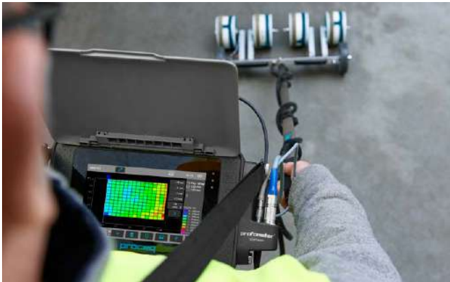
Profometer Corrosion con un electrodo de 4 ruedas
