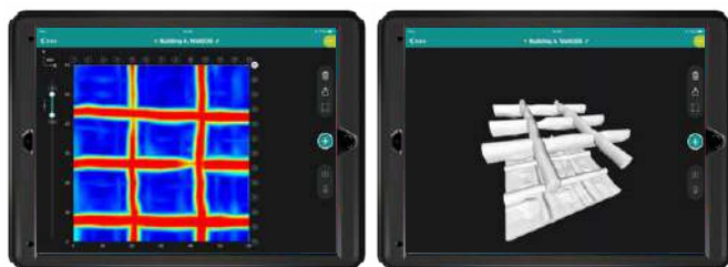
Proceq GPR Live Vista de intervalo de tiempo Proceq GPR Live Pro Vista 3D
