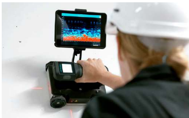
Sonda Proceq GPR Live combinada con porta tableta en el dispositivo
