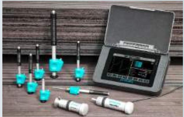
El **Equotip 550 Portable Rockwell** es una solución de medición de dureza estática, la cual es altamente apreciada para aplicaciones en muestras delgadas o ligeras. Adicionalmente, se le puede utilizar en prácticamente cualquier material sin necesidad de realizar ajustes especiales. Por ello, es usado muy frecuentemente como un método de referencia para otros principios de medición. Una amplia gama de accesorios le proporciona gran versatilidad.
