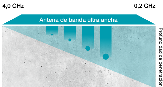
Proceq GPR Live cubre todas las frecuencias de 0,2 a 4,0 GHz con un solo dispositivo. Las frecuencias bajas permiten profundidades de penetración profundas y las frecuencias más altas permiten la detección de objetos pequeños.
