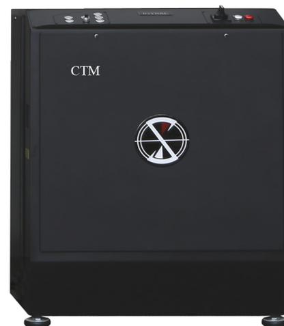
La prensa hidráulica modelo CTM, que pertenece a la serie PRO de HOYTOM, puede alcanzar capacidades nominales de hasta 6.000 kN. Este equipo está especialmente diseñado para realizar ensayos a compresión de probetas de hormigón cilíndricas, cúbicas y prismáticas, así como ensayos de tracción indirecta, cumpliendo con las normas correspondientes.
