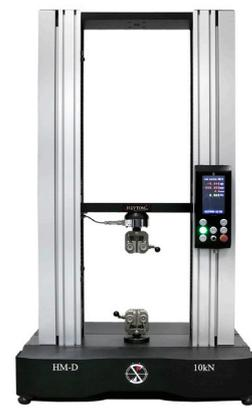
El modelo HM-D, que pertenece a la serie LAB de Hoytom, se fabrica para capacidades nominales de entre 5 y 1000 kN. Su célula de carga de alta calidad permite la máxima precisión en todo el rango de medida. Además, puede equiparse con una gran variedad de utillajes como mordazas de tracción, placas ranuradas en T, platos de compresión, útiles de flexión, extensómetros, etc.
