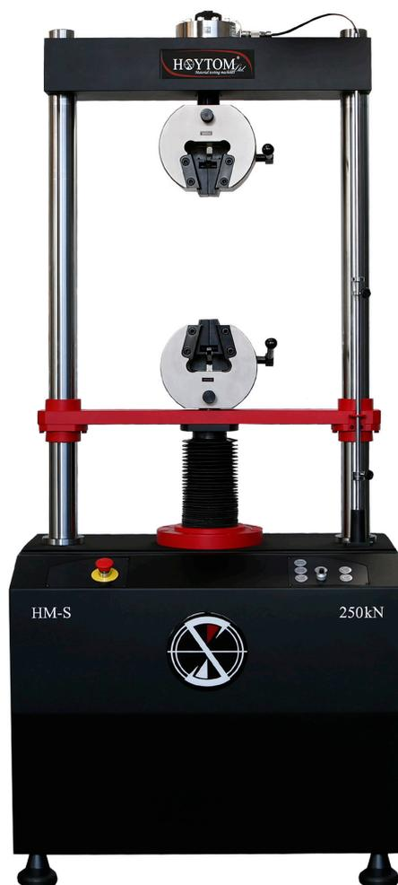
El modelo HM-S, que pertenece a la serie PRO de Hoytom, puede alcanzar capacidades nominales entre 100 y 250 kN. Sus células de carga de alta calidad permiten obtener una gran precisión en sus ensayos. Además, puede equiparse con una gran variedad de utillajes como mordazas de tracción, platos de compresión, útiles de flexión, extensómetros, etc.
