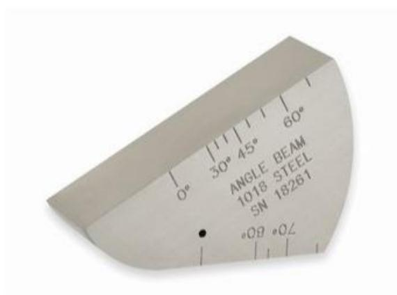
Este bloque miniatura de calibración para ultrasonido en haz angular, es también conocido como ROMPAS, y es la versión substituta ASTM y U.S. Air Force de bloque DSC, para calibración de distancia, punto índice del haz, angulo refractado y sensibilidad. Contiene un semicírculo con 1.0" de diámetro, opuesto a otro de 2.0", y también posee un barreno de 5/64" de diámetro, y 0.750" de profundidad.
