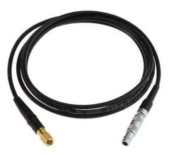
Cable coaxial tipo: C-120 para transductor DA590 de alta temperatura, 1.2m de largo.
