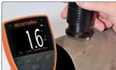
Las sondas integrales o separadas miden perfiles de hasta 500µm (20mils)
